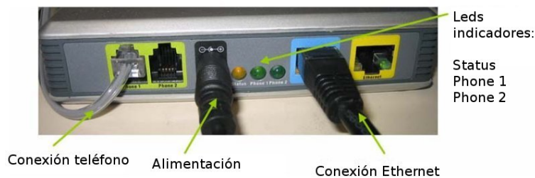
Figura 3.7: Conexiones ATA Linksys Sipura SPA-2100.
