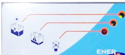
Figura 5.14: Indicadores del funcionamiento del controlador.
