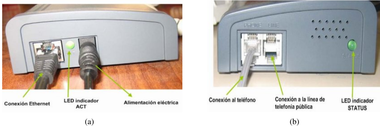
Figura 3.31: Conexiones ATA Linksys Sipura SPA-3000.
