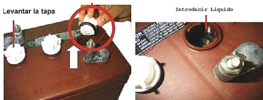
Figura 5.11: Revisión del nivel de líquido en la batería.
