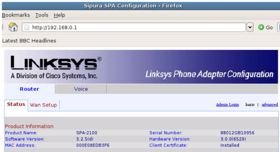
Figura 3.12: Configuración ATA Linksys Sipura SPA-2100. Paso 1.
