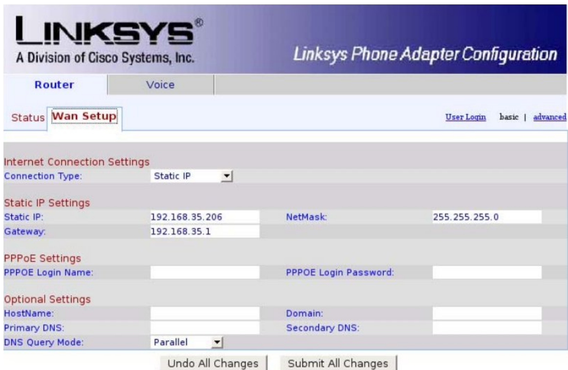
Figura 3.13: Configuración ATA Linksys Sipura SPA-2100. Paso 2.
